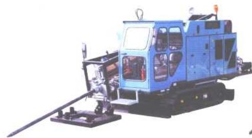
Grundodrill - système HDD, types 20 STD: DN ≤ 450, 350 m, force de poussée/traction 120 kN DN ≤ 600, 500 m, force de poussée/traction 200 kN
