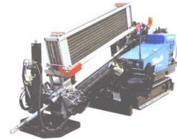
Grundodrill - système HDD, types: 10X, 13/15X TD: DN ≤ 350, 250 m, force de poussée/traction 100 kN DN ≤ 450, 350 m, force de poussée/traction 125 kN
