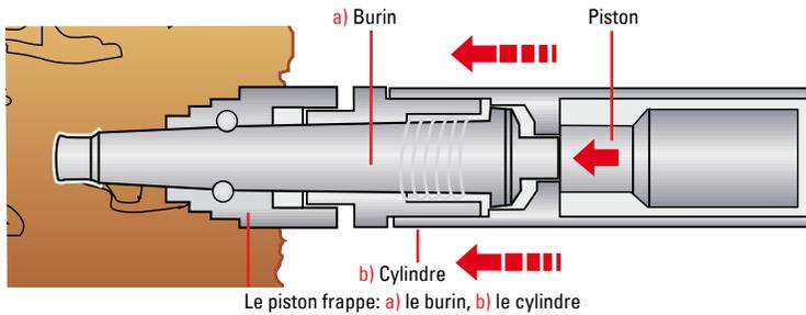
**Dans un 1er temps**, le piston frappe la pointe du burin. La tête de burin avance (forage pilote) tout en assurant un travail d'éclatement et de compression.
