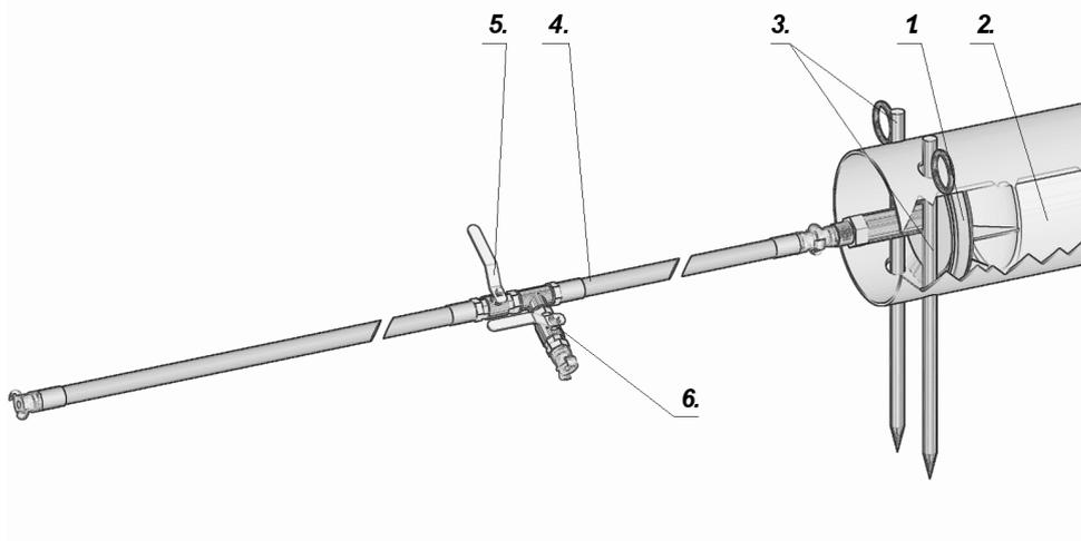
soufflage, le tuyau pneumatique **4** avec les vannes **5** et **6** pour la plaque de soufflage (fig. 8.11.1) (voir le chapitre 1.2 **Accessoires**) et l'ensemble de coupe à gaz.
