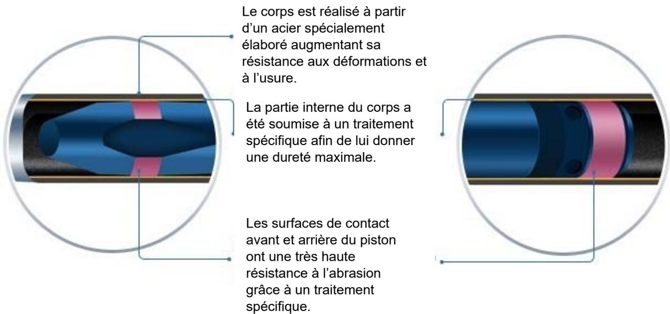
La très haute qualité de l'acier permet de réaliser des parois plus fines du corps de la fusée réduisant ainsi son poids et facilitant sa manipulation.
