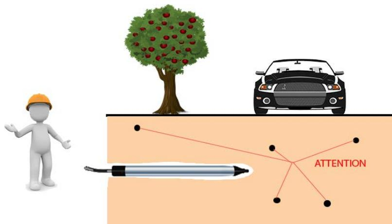
Les deux fouilles de départ et d'arrivée sont ouvertes avant de lancer la fusée (**Attention : Avant d'effectuer les fouilles, s'assurer de l'absence de réseaux**). La largeur sera de 60 à 80cm, la longueur 50cm plus grande que celle de la fusée. Même s'il n'y a pas de blindage d'ensemble, le front d'attaque doit impérativement être conforté par un panneau qui empêche la terre de tomber sur la fusée. Sinon, le réglage du tir ne peut-être garanti.
