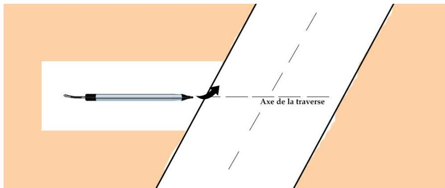
La visée de la trajectoire se fait avec une lunette, ou, de façon plus simple, avec une ficelle et un niveau. N'hésitez pas à passer du temps pour une visée précise, en plusieurs temps
