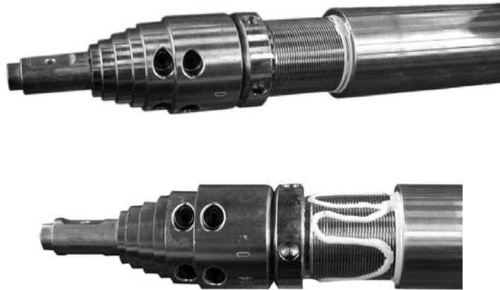
*Fig. 3-32 Application de LOCTITE 317 sur le filetage*
